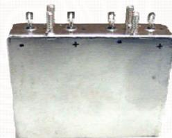
有一些特殊的应用，比如对脉冲功率有要求（快速充电）的混合电容技术，被用来达到更小的尺寸和（或）更低的串联有效电阻。各类型电容，比如陶瓷电容，固态钽电容和铝电解电容通常都可与湿钽联合使用。
